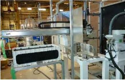
② 電極カット装置(レーザー)
