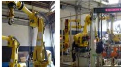
ロボットを用いたローラーでのヘミング
