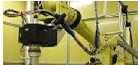
ロボットにレーザーヘッドを取り付け
