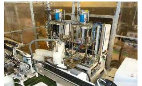
⑦ セル外観検査装置(カメラ判定)
