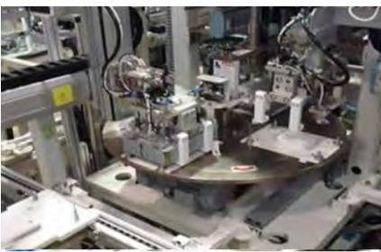
⑫ 検査装置(絶縁抵抗計測)
