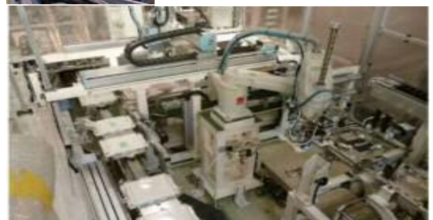
《リチウムイオン電池モジュール組立設備》
